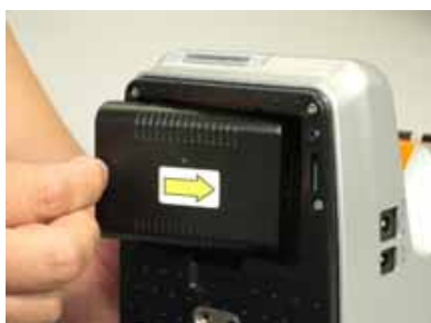
2. Lắp Pin vào máy như hình vẽ.
