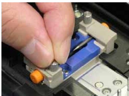
6. Lắp lại bộ phận 2 và bộ phận 5 để vị trí điện cực khác. Luôn thay cả hai điện cực cùng một lúc. 7. Bật nguồn máy hàn và vào mạch Thay thế điện cực (chi tiết trên trang 44.)
