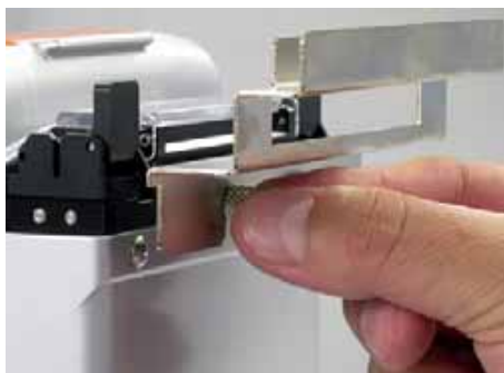
3. Vỡ nắp nhựa để lộ các bộ phận bên trong và đặt khay làm mát vào máy.
