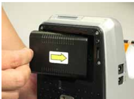
1. Lắp Pin vào máy hàn TYPE-25e.
