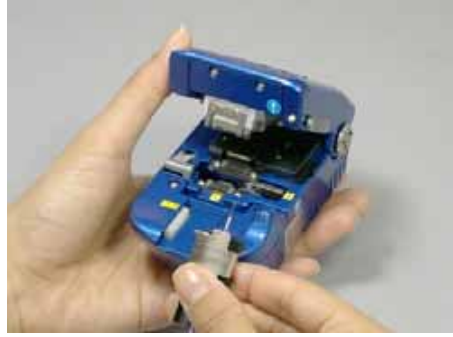
5. Bỏ bỏ giũa sợi quang khi dao cắt FC-7.
