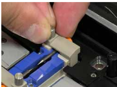
5. Lắp điện cực mới. Lưu ý chèn các đầu điện cực trong vị trí nút nhô ra để điện cực
